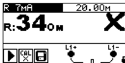
Рисунок 5.14: Пример результата непрерывного измерения R 7mA
