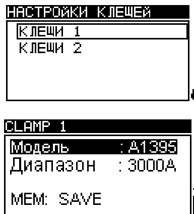
Рисунок 4.5: Настройка измерительных входов токовых клещей
