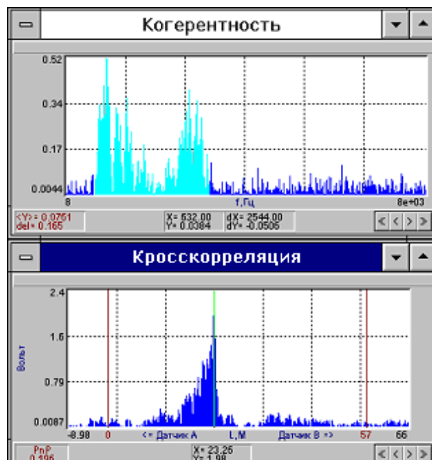
Рис.42. Определение места утечки (полоса анализа 632- 3176 Гц).
