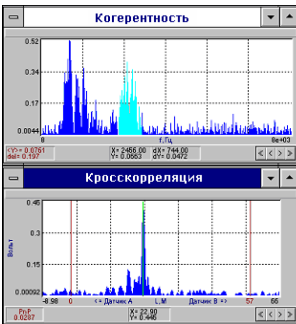
Рис.41. Определение места утечки (полоса анализа 2456- 3200 Гц).
