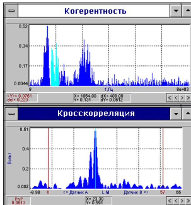
Рис.40. Определение места утечки (полоса анализа 1064- 1472 Гц).
