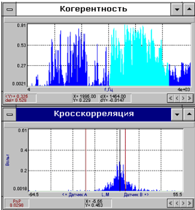
Рис.50 Функции когерентности и кросс корреляции при 2-й проверке магистрального сегмента (рис.47).
