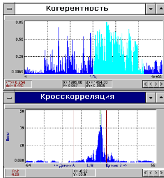
Рис.49 Функции когерентности и кросс корреляции для проверки по рис.47
