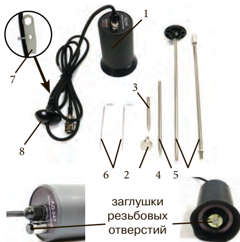
Рис.2 Состав акустического датчика
