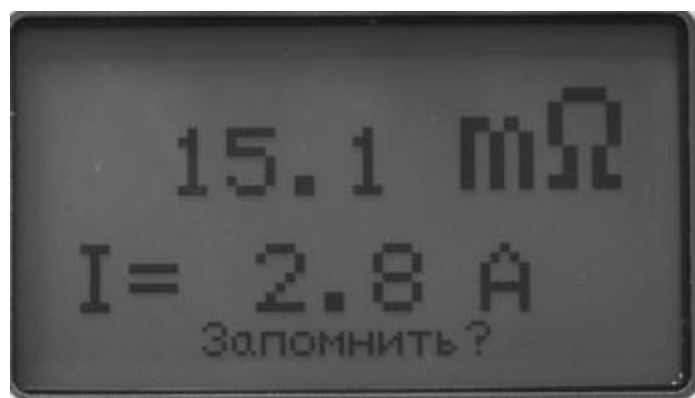
Рисунок 6.4 Видеogramма результата измерения.
