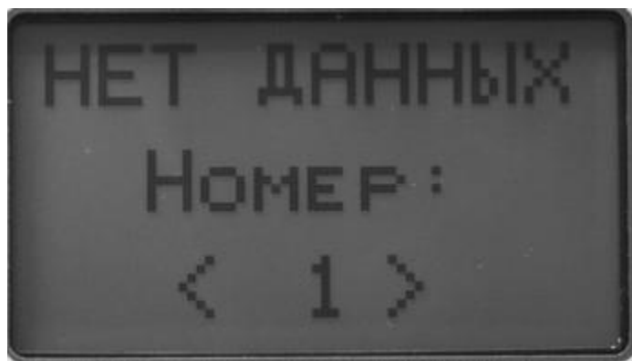
Рисунок 6.17 Отображение при незаполненной ячейке памяти.
