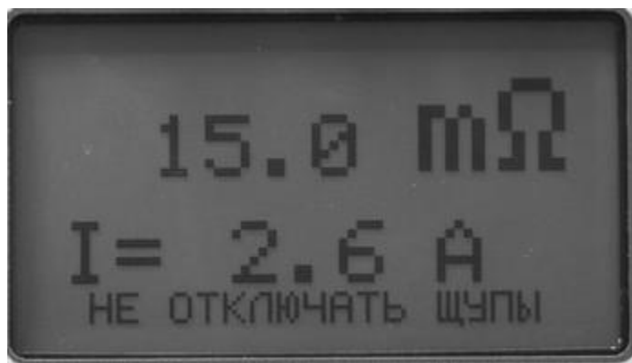
Рисунок 6.10 Вывод результата измерения с предупреждением «не отключать щупы»
