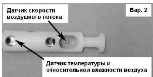
На рисунке показаны несколько вариантов исполнения наконечника сенсометрического щупа.
