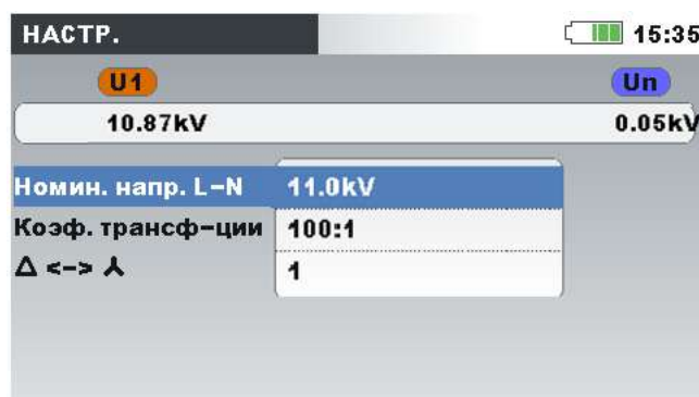
Рисунок 4.13: Коэффициент трансформации трансформатора 11 кВ/110 кВ (для примера)
