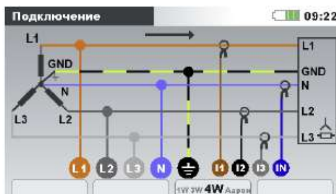
Рисунок 4.3: Выбор 3-фазной 4-проводной системы на приборе
