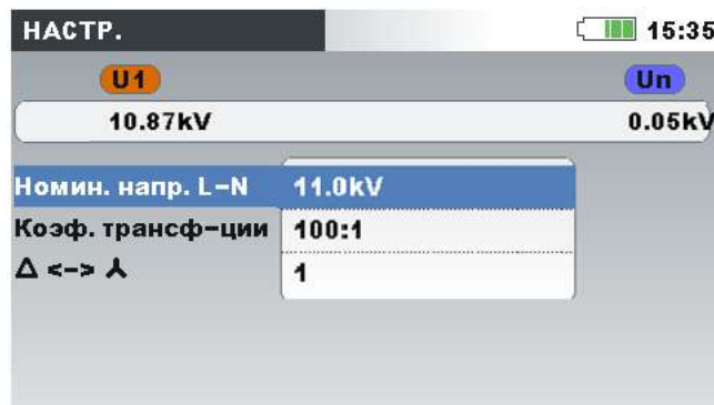
Рисунок 4.13: Коэффициент трансформации для трансформатора 11 кВ/110 кВ (пример)
