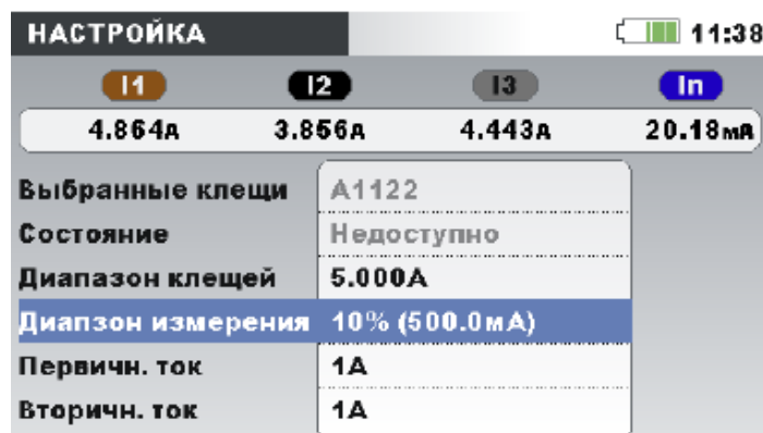
Рисунок 4.17: Выбор 10-процентного диапазона для токовых клещей
