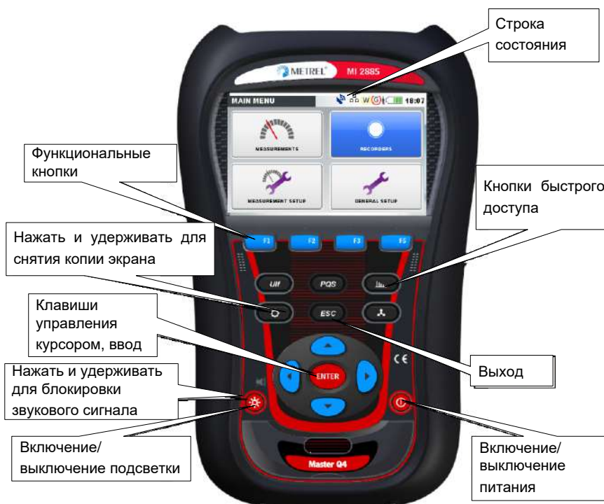
Рисунок 3.1: Описание символов дисплея и клавиш
