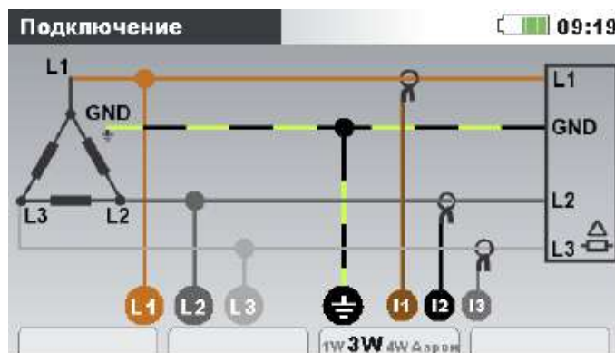
Рисунок 4.5: Выбор 3-фазной 3-проводной системы на приборе
