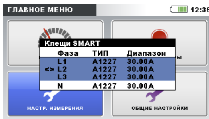
Рисунок 4.19: Состояние автоматически распознаваемых токовых клещей
