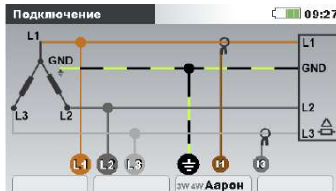
Рисунок 4.7: Выбор 3-проводной системы в виде разомкнутого треугольника (схема Арона) на приборе
