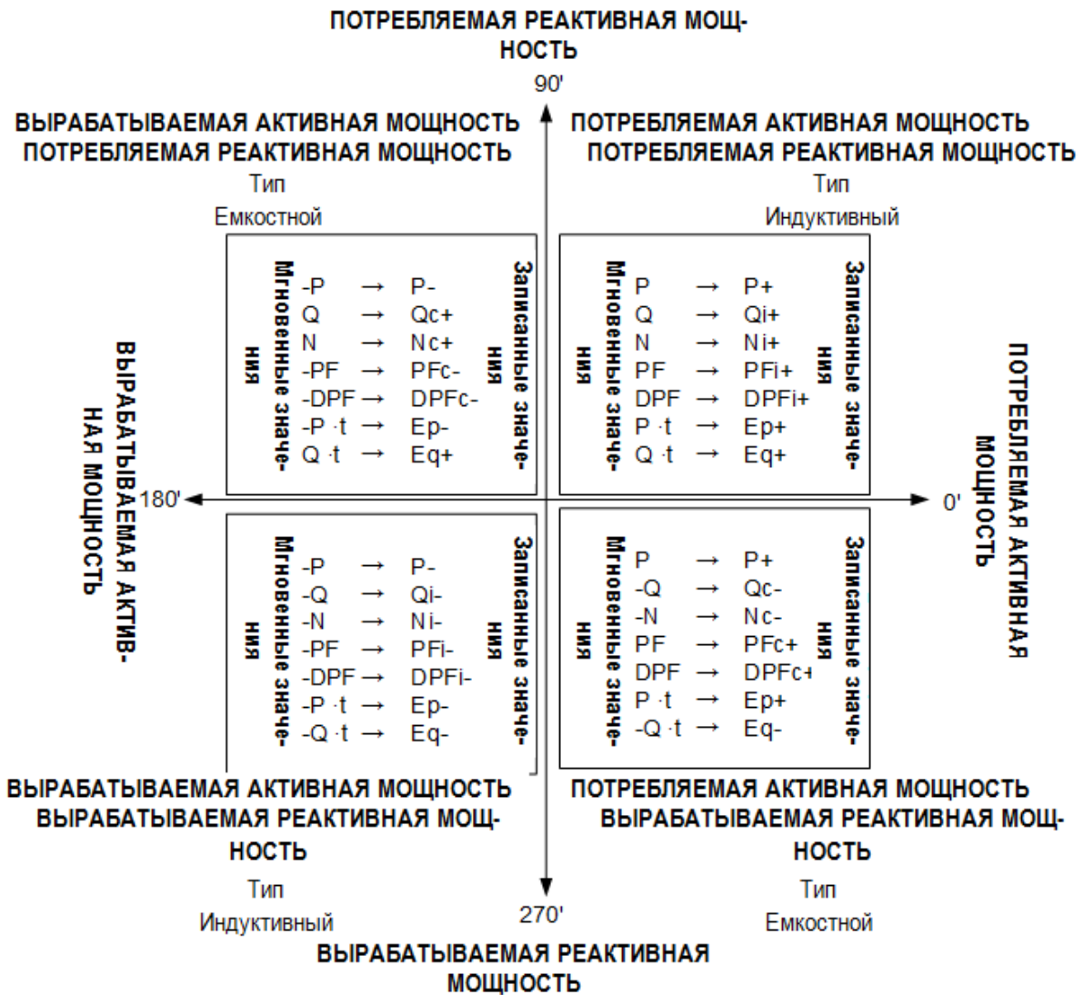
Рисунок 5.15: Фазовая диаграмма/диаграмма полярности потребляемой/генерируемой и индуктивной/емкостной мощности
