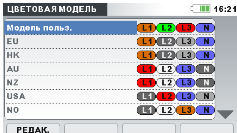
Рисунок 3.74: Цветовое представление фазных напряжений
