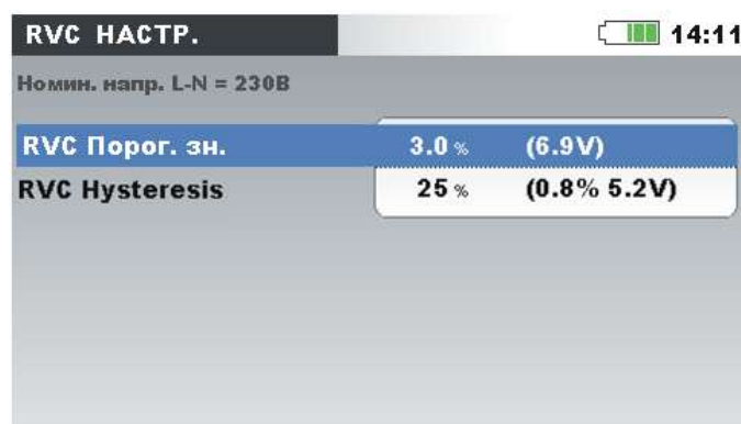
Рисунок 3.6: Экран настройки функции RVC
