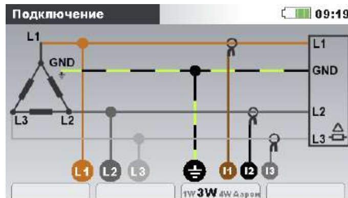
Рисунок 4.4: Выбор 3-фазной 3-проводной системы на приборе
