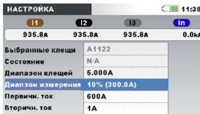
Рисунок 4.20: Выбор 10-процентного диапазона для токовых клещей
