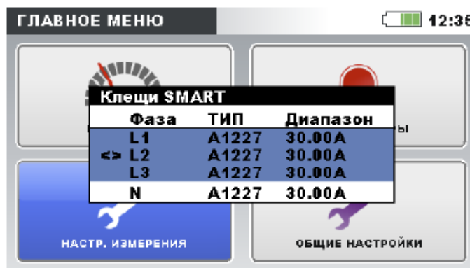
Рисунок 4.22: Состояние автоматически распознаваемых токовых клещей
