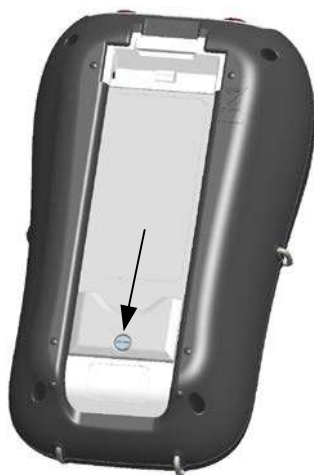
Рисунок 7.2: Закрытие крышки аккумуляторного отсека
