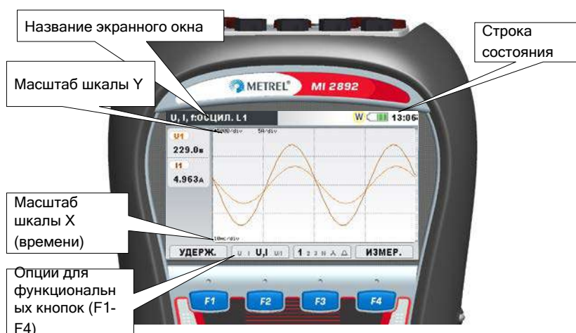
Рисунок 3.2: Общие символы и метки, отображаемые на дисплее при выполнении измерений
