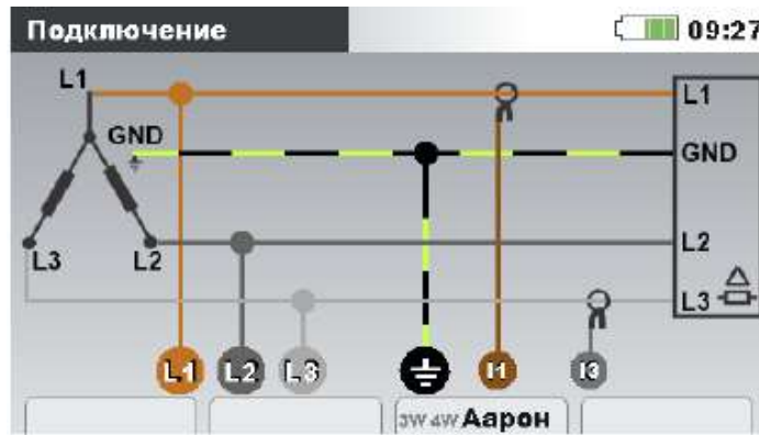
Рисунок 4.6: Выбор 3-проводной системы в виде разомкнутого треугольника (схема Аарона) на приборе
