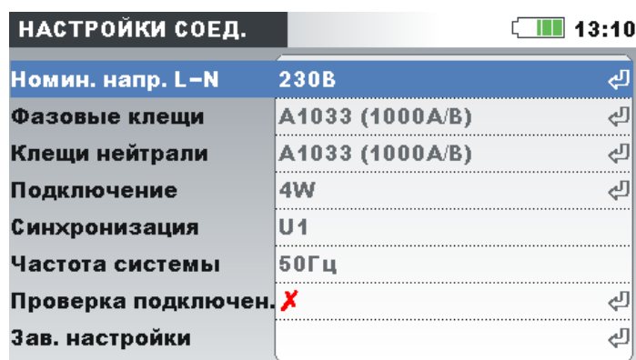
Рисунок 3.2: Экран «CONNECTION SETUP» (НАСТРОЙКА СОЕДИНЕНИЯ)
