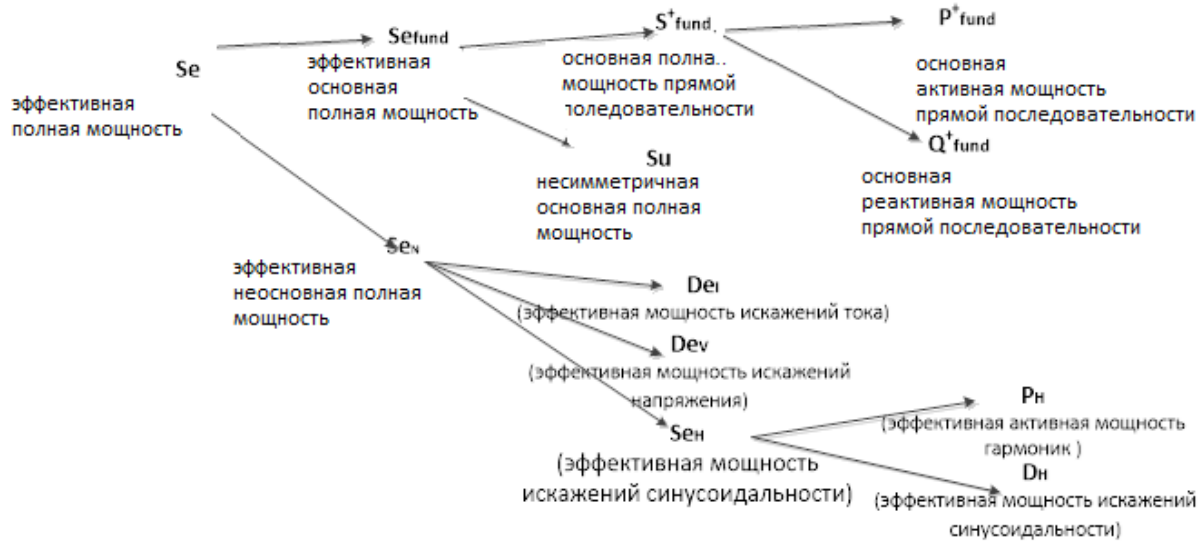
Рисунок 5.3: Организация измерения мощности фазы согласно стандарту IEEE 1459 (полная)
