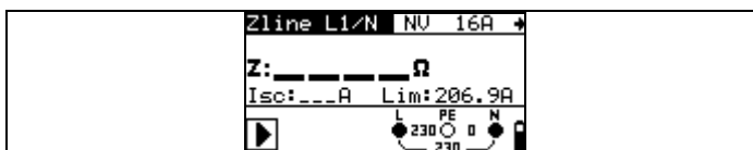
Рисунок 5.49: Полное сопротивление линии
