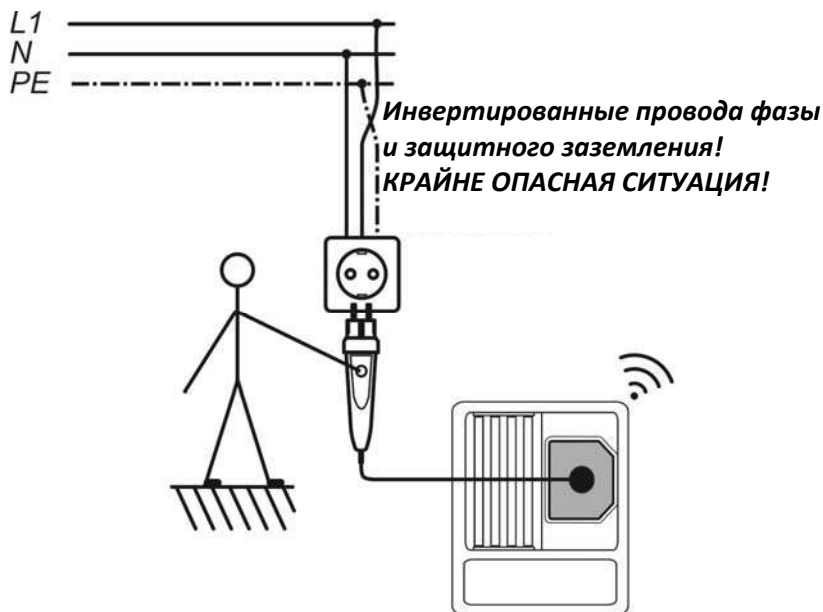
Рисунок 5.69: Инвертированные провода фазы и защитного заземления (L и PE) (щуп типа коммандер с вилкой (plug commander))
