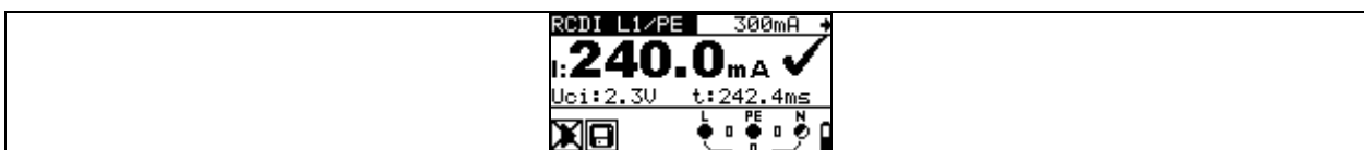
.....Рисунок 5.39 - Пример результата измерения тока отключения
