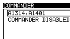
Рисунок 4.5: Выбор поддержки дистанционных щупов типа «commander»
