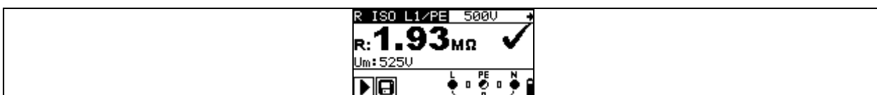
Рисунок 5.4: Пример результатов измерения сопротивления изоляции
