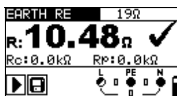
Рисунок 5.27: Пример результатов измерения сопротивления заземления
