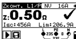
Рисунок 5.28: Примеры результатов измерения импеданса контура
