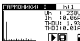
Рисунок 5.49: Примеры результатов измерения гармоник
