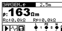
Рисунок 5.42: Пример результатов измерения удельного сопротивления грунта
