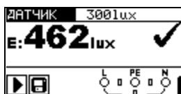
Рисунок 5.58: Пример результата измерения освещенности
