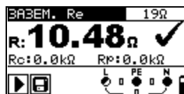
Рисунок 5.38: Пример результатов измерения сопротивления заземления
