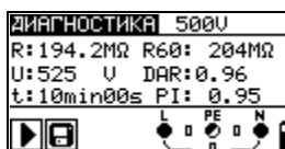
Рисунок 5.10: Пример с результатами диагностических испытаний PI и DAR
