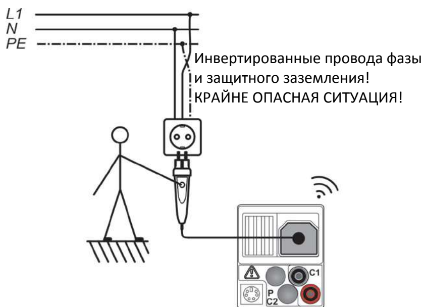
Рисунок 5.43: Инвертированные провода фазы и защитного заземления (L и PE) (щуп типа командер с вилкой (plug commander))
