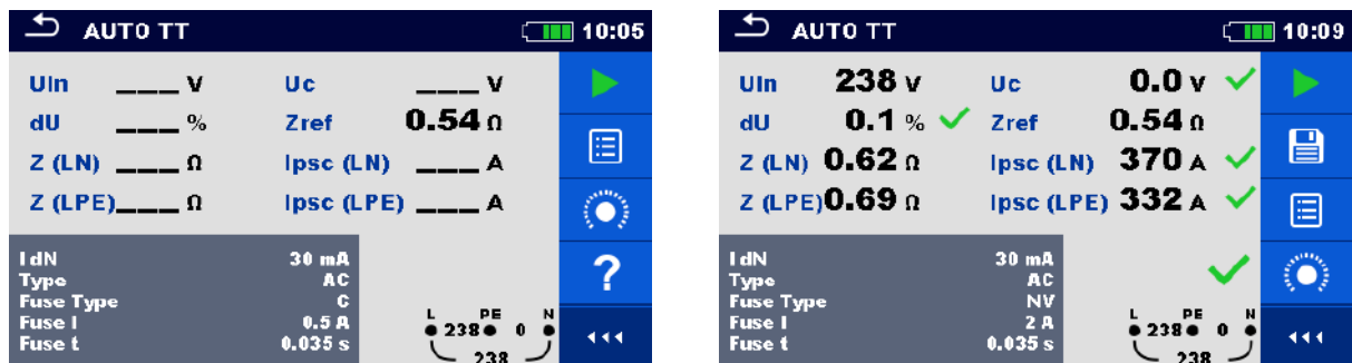
Рисунок 8.5: Примеры с результатов измерения АВТО ТТ.
