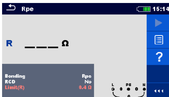
Рисунок 7.74: Меню измерения сопротивления провода защитного заземления.
