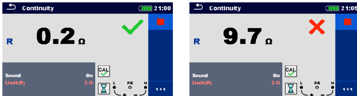
Рисунок 7.19: Примеры результата непрерывного измерения сопротивления изоляции.
