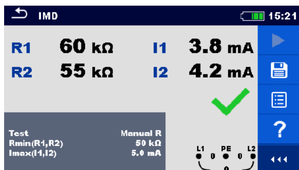
Рисунок 7.73: Пример результатов испытания IMD (устройства контроля изоляции).
