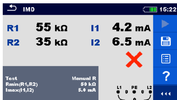
Рисунок 7.73: Пример результатов испытания IMD (устройства контроля изоляции).
