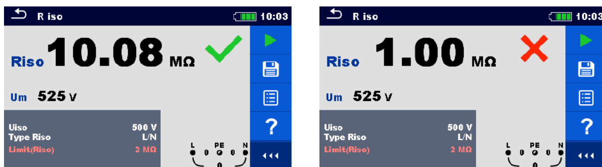
Рисунок 7.9: Примеры результатов измерения сопротивления изоляции.
