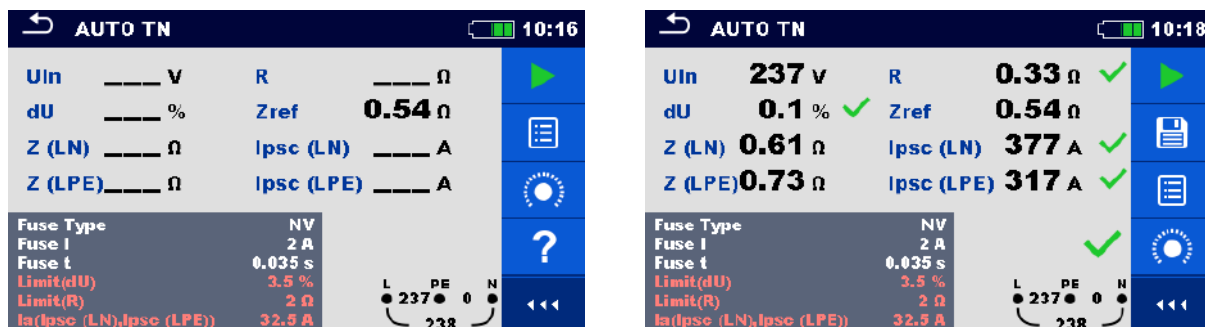
Рисунок 8.11: Примеры с результатов измерения АВТО TN.
