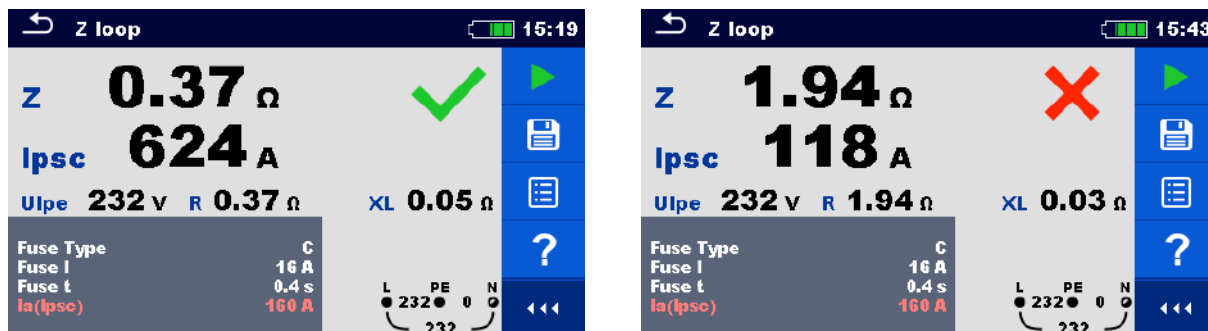
Рисунок 7.30: Пример результатов измерения полного сопротивления контура.
