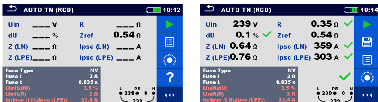
Рисунок 8.8: Примеры результатов измерения АВТО TN (УЗО).
