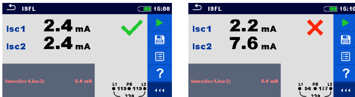
Рисунок 7.70: Примеры результатов измерения тока утечки первичного повреждения.
