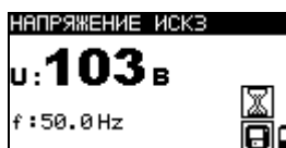
Рисунок 6.10: Результат измерения напряжения
