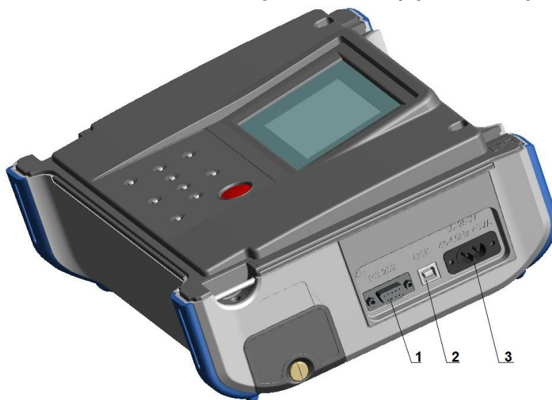
Рисунок 3.3: Соединительные и сетевой разъемы
