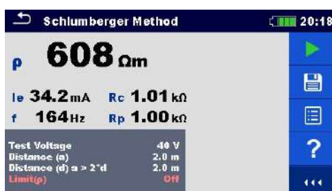
Рисунок 11.42: Пример результатов измерения методом Шлумбергера
