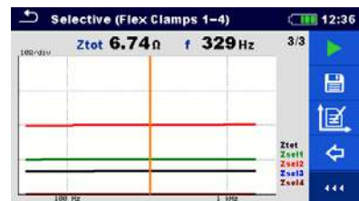
Рисунок 11.29: Пример графического отображения результатов селективного измерения (гибкими клещами)
