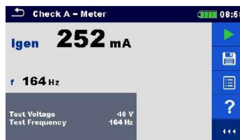
Рисунок 11.91: Пример результатов проверки амперметра
