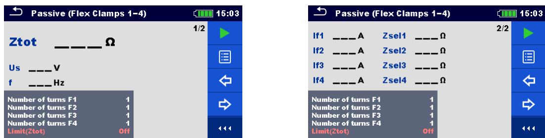
Рисунок 11.32: Меню пассивного измерения гибкими клещами
