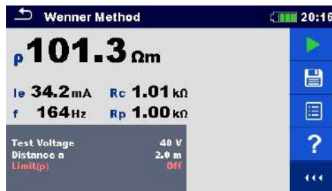
Рисунок 11.39: Пример результатов измерения методом Веннера
