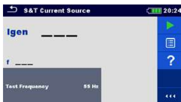
Рисунок 11.69: Меню генерируемого тока для напряжения прикосновения и шагового напряжения
