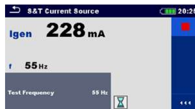
Рисунок 11.70: Пример отображения результата генерируемого тока для определения напряжения прикосновения и шагового напряжения
