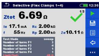
Рисунок 11.27: Пример цифрового отображения результатов селективного измерения (гибкими клещами) – Z tot
