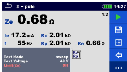
Рисунок 11.8: Пример цифрового представления результата 3-проводного измерения
