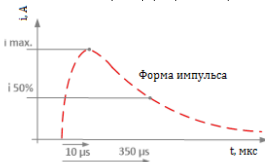
Рисунок 15.2: Типовая форма импульса короткого замыкания
