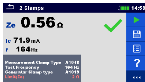
Рисунок 11.20: Пример результата измерения двумя клещами
