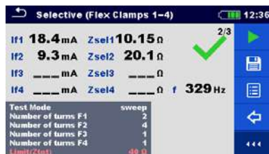
Рисунок 11.28: Пример цифрового отображения результатов селективного измерения (гибкими клещами) – Z sel1-4
