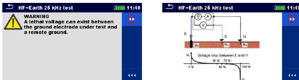
Рисунок 12.4: Автоматическое измерение – пример паузы с выдачей сообщения (текстового или графического)
