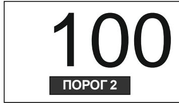
При индикации значений ПОРОГ 1 и ПОРОГ 2 происходит срабатывание звуковой, световой и вибросигнализации, с соответствующей интенсивностью вибрации, частотой звуковой сигнализации и частотой мигания светофиода.
