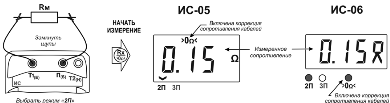
Рисунок 6 – Схема подключения и вид индикатора при двухпроводном методе измерения
